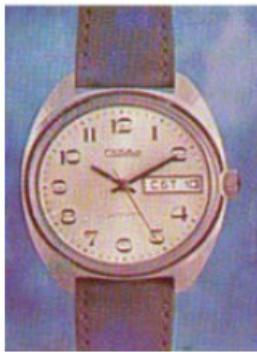
Корпус хромированный, фасонный, полированный, лицевая поверхность обработана алмазным инструментом. Крышка из нержавеющей стали. Циферблат из мельхиора, с радиально-штрихованным полем, серебреный. Оцифрован одиннадцатью печатными арабскими часовыми знаками черного цвета. Стрелки плоские, никелированные. Окна часовой и минутной стрелок заполнены черной краской. Секундная стрелка красная.
