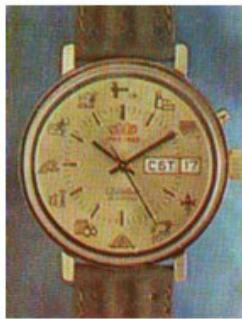
Корпус золоченый, внешняя поверхность обработана алмазным инструментом. Крышка из нержавеющей стали. Циферблат радиально-штрихованный, серебреный, золотистого цвета. Оцифрован одиннадцатью высадными часовыми знаками золотистого цвета. Стрелки плоские, золоченые, с черным заполнением окон. Секундная стрелка синяя.
