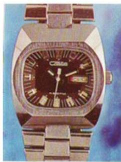
Корпус с браслетом хромированный, сложной огранки с внешней поверхностью, обработанной алмазным инструментом и шлифованием. Крышка из нержавеющей стали. Циферблат с чеканенными поперечными штрихами, покрыт лаком темно-коричневого цвета, оцифрован одиннадцатью накладными знаками серебристого цвета. Стрелки переменного сечения, никелированные, с полосой. Секундная стрелка красная.
