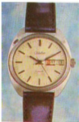
Корпус хромированный, фасонный, полированный, лицевая поверхность обработана алмазным инструментом. Крышка из нержавеющей стали. Циферблат мельхиоровый, с рельефным чеканенным полем, серебреный, оцифрован одиннадцатью высадными часовыми знаками серебристого цвета. Стрелки плоские, полированные, с черной полосой. Секундная стрелка синяя.
