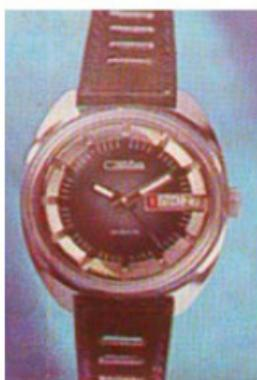
Корпус хромированный, фасонный, полированный, лицевая поверхность обработана алмазным инструментом. Крышка из нержавеющей стали. Циферблат двухдатчайный, состоит из диска и накладного кольца с двенадцатью прорезными часовыми знаками. Между знаками декоративные риски. Диск циферблата аэрографирован в синий цвет. Стрелки плоские, никелированные, с белой эмалью. Секундная стрелка никелированная.
